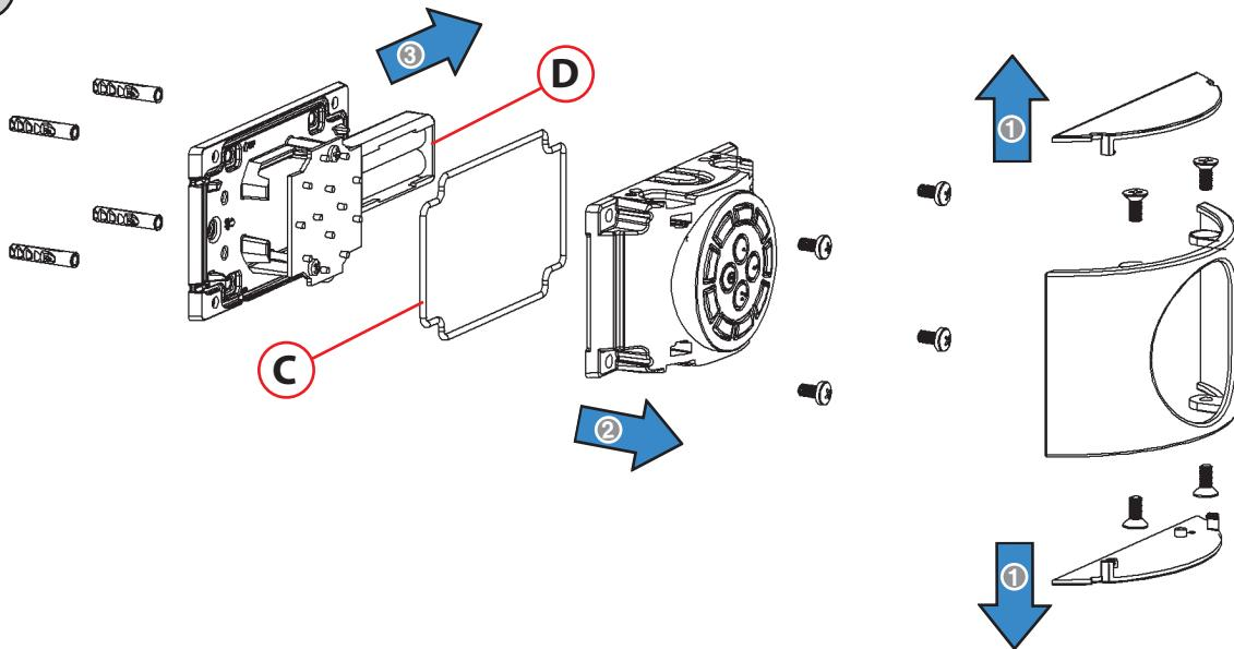
**I SOSTITUZIONE DELLE BATTERIE****EN REPLACING THE BATTERY****F SUBSTITUTION DES BATTERIES****AUSTAUSCH DER BATTERIEN****E CAMBIO DE LAS PILAS****PT SUBSTITUIÇÃO DAS PILHAS****King Gates S.r.l.**
